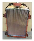
leistungsstärktes Netz eingelötet, das Überlaufröhrchen und der obere Stutzen wurden ebenfalls erneuert.
